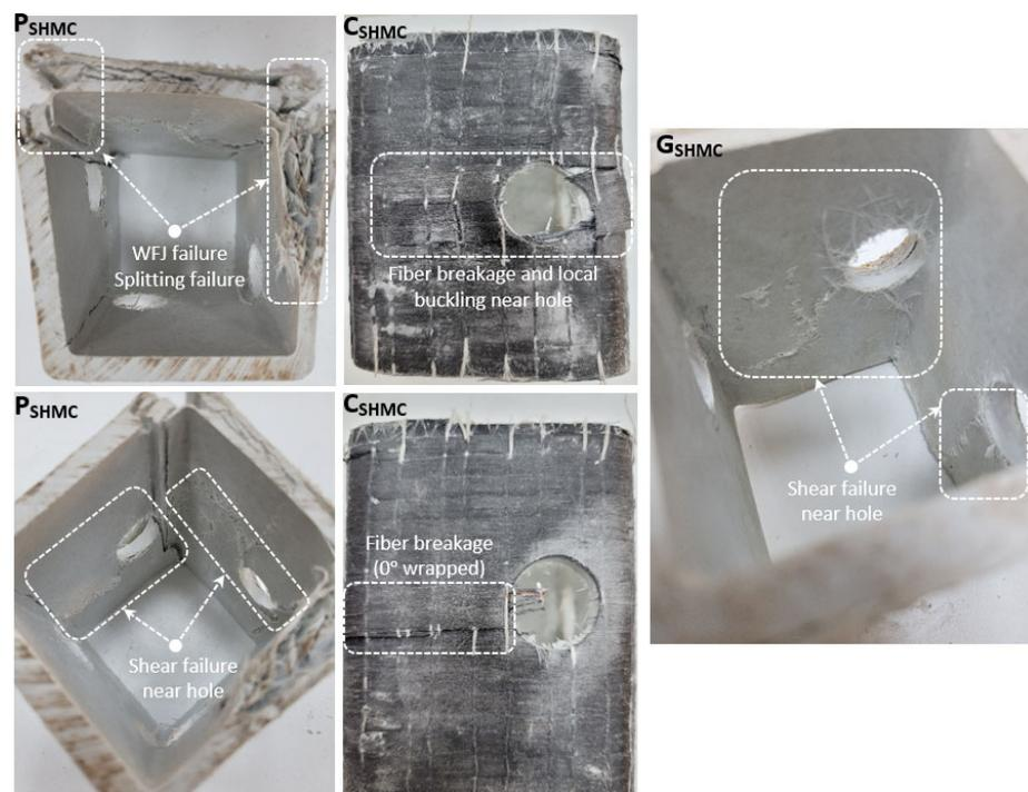
**Figure 5.** Damage analyses of  $P_{SHMC}$ ,  $C_{SHMC}$ ,  $G_{SHMC}$ .
