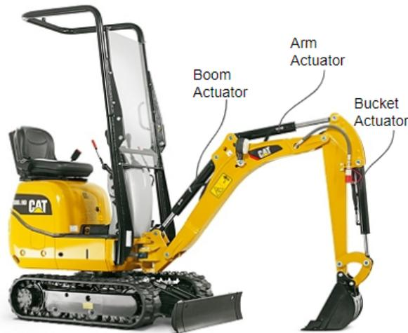
Figure 1. The conventional CAT mini excavator [23].
