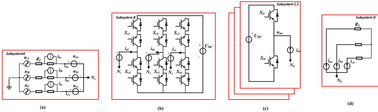
Figure 9. IMC decoupling: (a) power side, (b) rectifier side, (c) inverter side, (d) load side.
