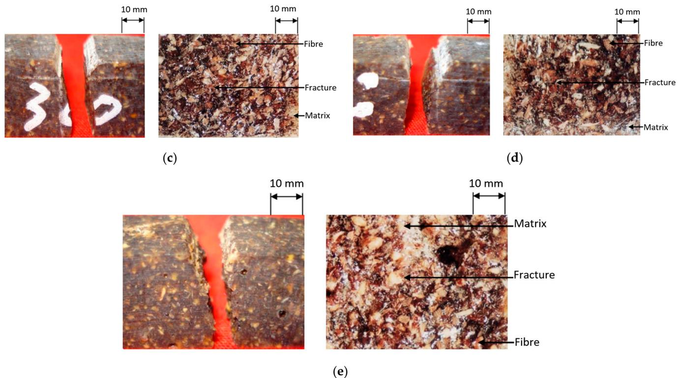
**Figure 8.** Cross section macro photo of impact test specimen  $V_f = 10\%$  (a),  $20\%$  (b),  $30\%$  (c),  $40\%$  (d) and  $V_f = 50\%$  (e).
