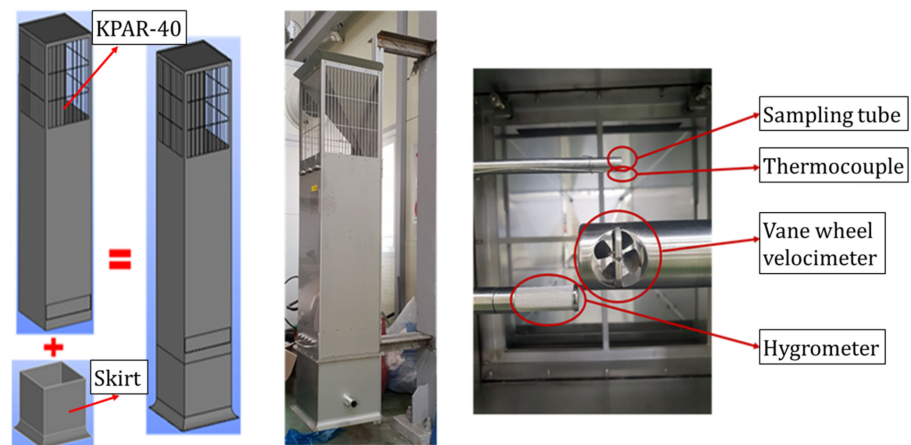
Figure 4. Construction of test PAR using a KPAR-40 PAR.
