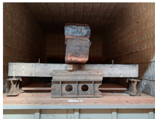
(d) Service load of 65 kN
