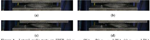
Figure 1. Lateral cyclic tests on FREB. (a)  $u_h = 0\% t_r$ . (b)  $u_h = 1.0\% t_r$  (c)  $u_h = 1.5\% t_r$ . (d)  $u_h = 2.0\% t_r$ .
