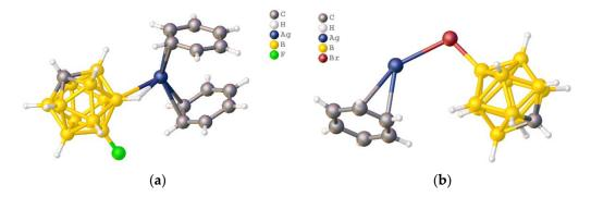
**Figure 22.** Structures of (a)  $[Ag(C_6H_6)_2[12-CB_{11}H_{11}F]]$  and (b)  $[Ag(C_6H_6)[12-CB_{11}H_{11}Br]]$ .
