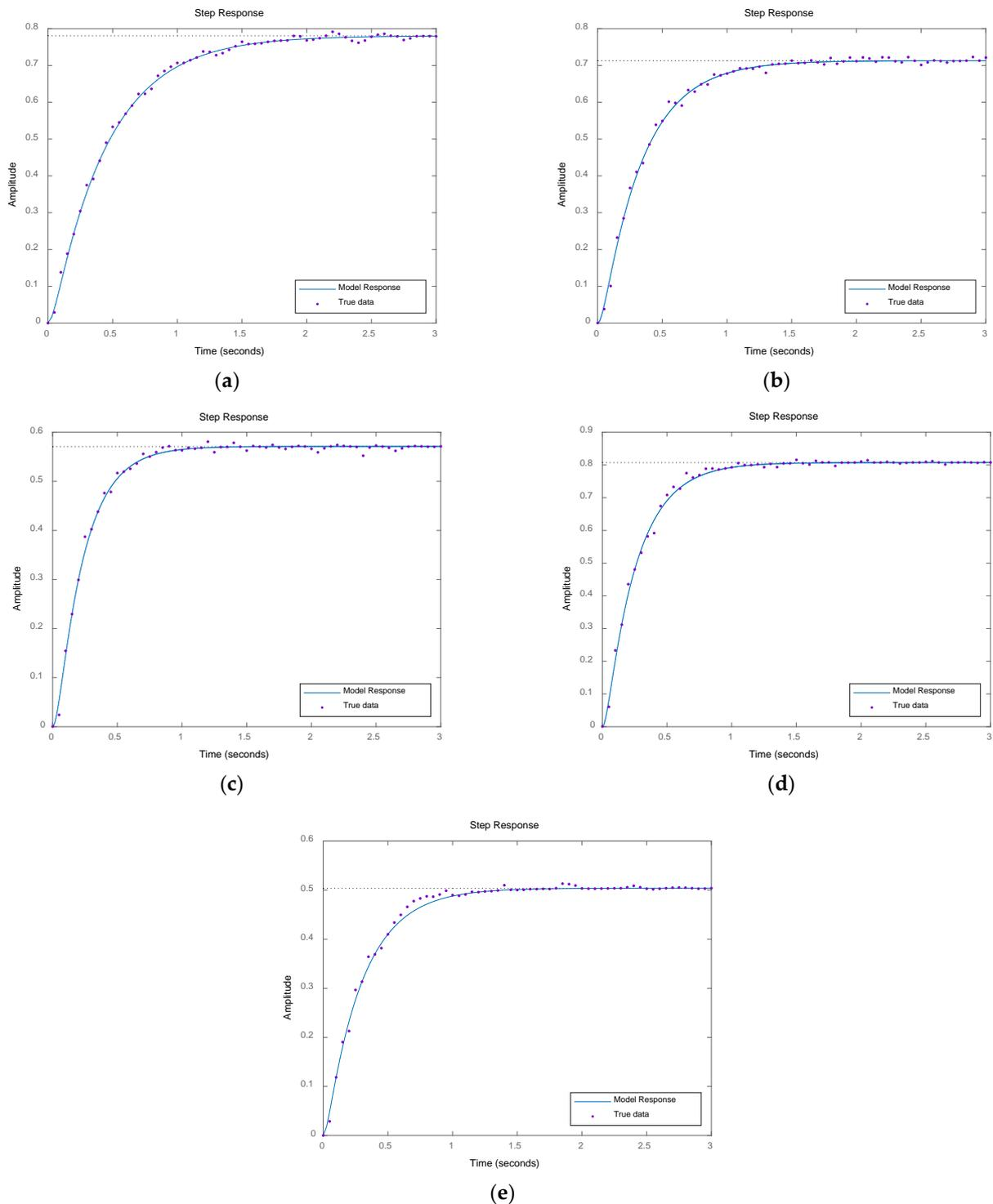
**Figure 3.** Model response under step input. (a) Mach 0.4. (b) Mach 0.6. (c) Mach 0.8. (d) Mach 1.0. (e) Mach 1.2.
