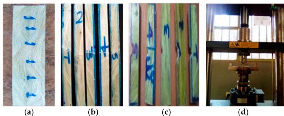
**Figure 2.** (a) Tensile, (b) flexural, (c) impact test specimen and (d) UTM.
