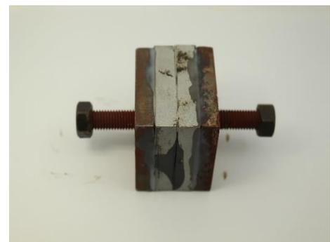
(d) Test specimen assembly
