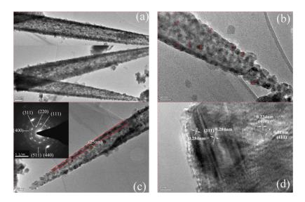
Figure 4. (a-c) TEM and (inset) SAED and (d) HRTEM images of NiCo<sub>2</sub>S<sub>4</sub> nanotube.
