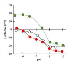
**Figure 6.** pH dependencies of the ζ-potential of **Sil-0** (—-), **Sil-P**<sub>17</sub>/H<sub>75</sub>-0 (—-), and **Sil-P**<sub>17</sub>/H<sub>75</sub>-H<sub>560</sub> (—-).
