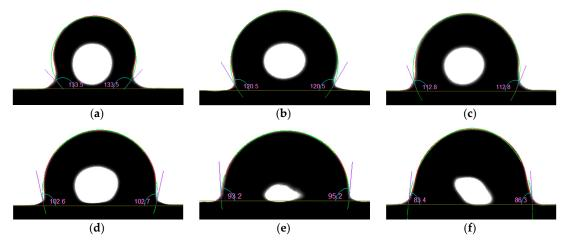
**Figure 3.** Static contact angle of samples under different years: (a)  $A_1$ ; (b)  $A_2$ ; (c)  $A_3$ ; (d)  $A_4$ ; (e)  $A_5$ ; (f)  $A_6$ .
