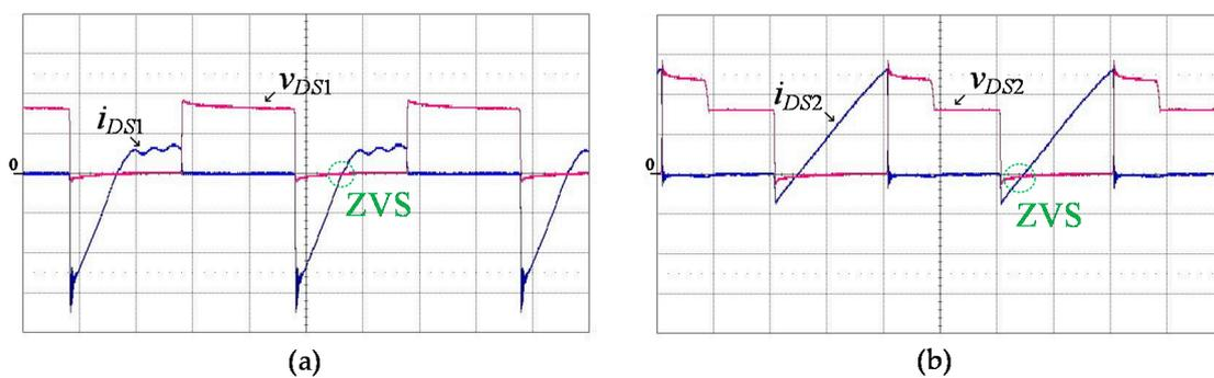
Figure 8. Waveforms of the voltages and currents of the active switches. (a)  $v_{DS1}$  and  $i_{S1}$  ( $v_{DS1}$ : 200 V/div,  $i_{S1}$ : 1 A/div, time: 5  $\mu$ s/div) and (b)  $v_{DS2}$  and  $i_{S2}$  ( $v_{DS1}$ : 200 V/div,  $i_{S1}$ : 1 A/div, time: 5  $\mu$ s/div).
