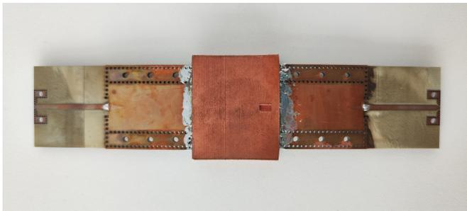
(d) Printed part (Dowell pins).
