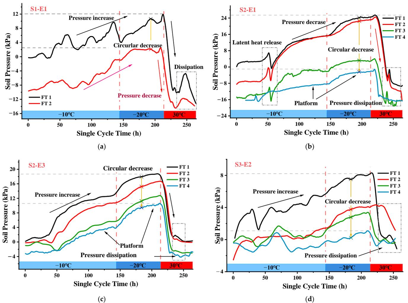
Figure 10. Soil pressure of the slope model in four freeze-thaw cycles. (a) S1-E1; (b) S2-E1; (c) S2-E3; (d) S3-E2.
