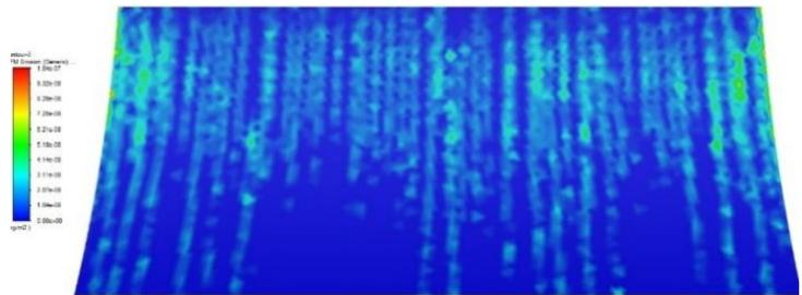
(d) Erosion cloud diagram of gate leaf.
