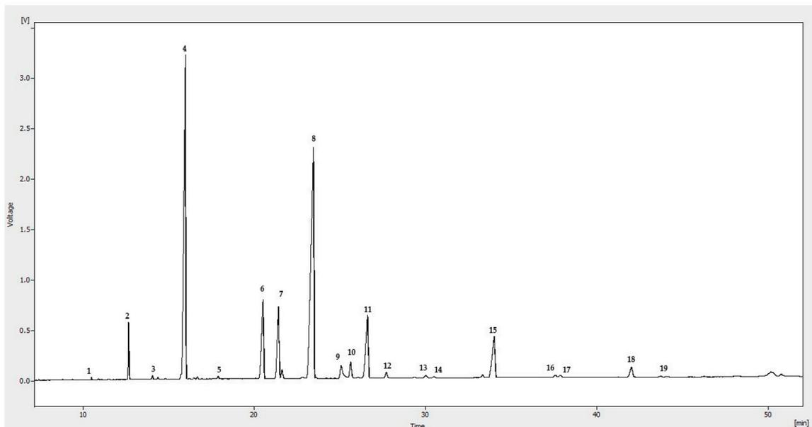
**Figure 6.** Typical chromatogram of fatty acids profile in coffee silverskin fat (1—C12:0; 2—C14:0; 3—C15:0; 4—C16:0; 5—C16:1; 6—C18:0; 7—C18:1; 8—C18:2; 9—C18:3 n-6; 10—C18:3 n-3; 11—C20:0; 12—C20:1; 13—C21:0; 14—C20:2; 15—C20:3; 16—C22:2; 17—C24:0; 18—C20:5; 19—C24:1).
