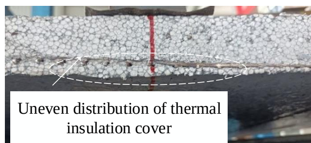
Figure 8. Actual steel wire mesh position.
