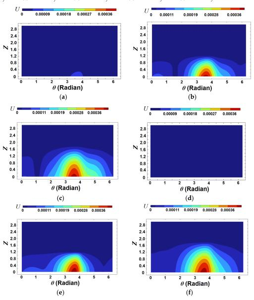
**Figure 13.** Distributions of the dimensionless deformation for  $\varepsilon' = 0.2$ . (a) A = 0.4,  $L_f = 0.15$ ; (b) A = 0.4,  $L_f = 0.4$ ; (c) A = 0.4,  $L_f = 0.6$ ; (d) A = 0.8,  $L_f = 0.15$ ; (e) A = 0.8,  $L_f = 0.4$ ; (f) A = 0.8,  $L_f = 0.6$ .
