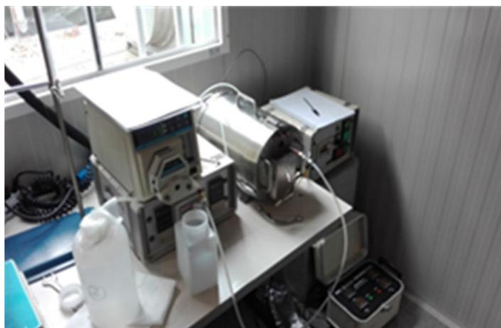
**Figure 2.** The butanol vaporisation system.
