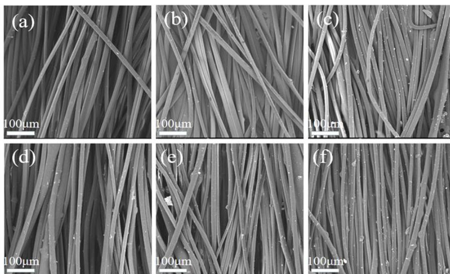
**Figure 2.** The SEM images of e-spun PP fibers containing ZnO: (a) 0 wt.%; (b) 1 wt.%; (c) 2 wt.%; (d) 3 wt.%; (e) 4 wt.%; (f) 5 wt.%.
