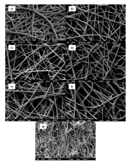
**Figure 2.** SEM images of (**a**) pure EVA, (**b**) EVA/0.1 wt % MWCNTs, (**c**) EVA/1.0 wt % MWCNTs, (**d**) EVA/1.5 wt % MWCNTs, (**e**) EVA/2.0 wt % MWCNTs, (**f**) EVA/2.5 wt % MWCNTs, and (**g**) EVA/3.0 wt % MWCNTs.
