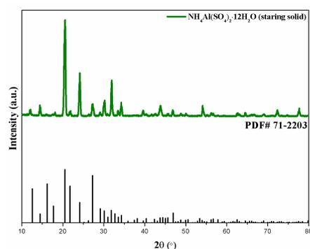
Figure 1. XRD patterns of  $\text{NH}_4\text{Al}(\text{SO}_4)_2 \cdot 12\text{H}_2\text{O}$  (starting solid).
