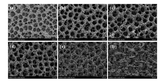
**Figure S11.** The SEM images of A-Cu/SnO<sub>2</sub> with different SnO<sub>2</sub> deposition time, (a)0 min, (b) 5 min, (c) 15 min, (d) 30 min, (e) 45 min, (f) 60 min.
