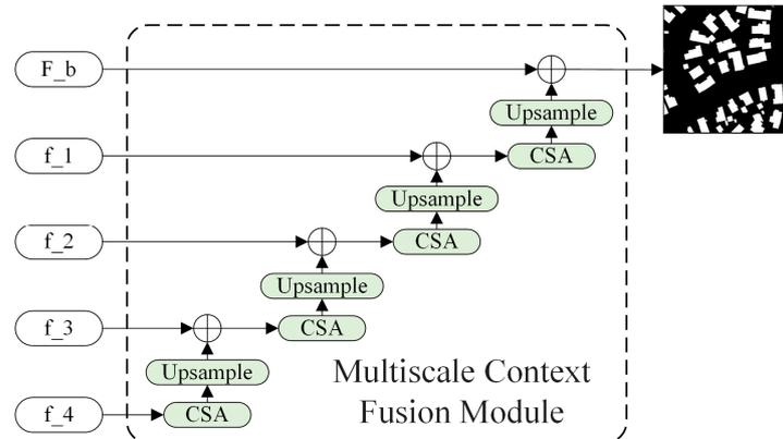
Figure 4. Multi-scale context fusion module (MCFM).
