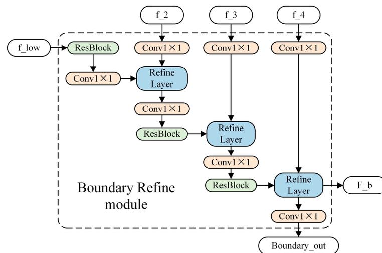
**Figure 2.** Boundary-refinement module (BRM).
