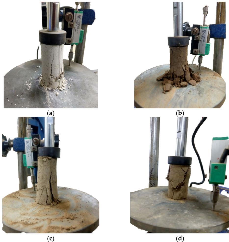
**Figure 6.** Failure of UCS specimens: (a) CH + Gelatin; (b) CL + Gelatin; (c) ML + Gelatin; (d) CL.
