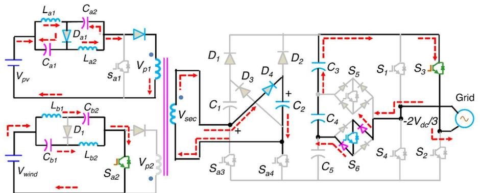
(d) Fourth interval of a negative half cycle
