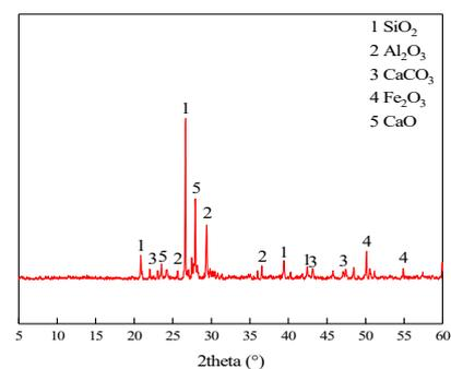
(d) XRD diffraction pattern of RP
