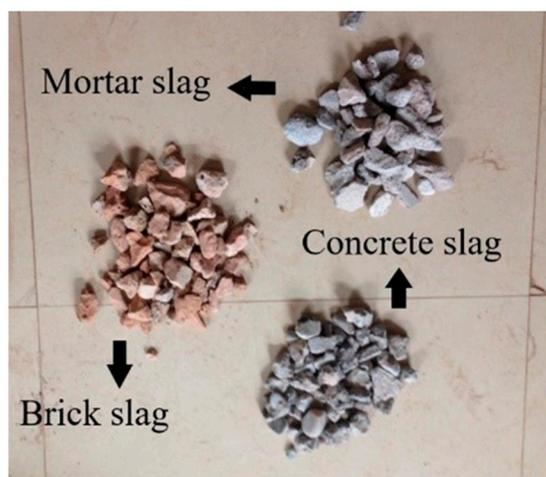
Figure 1. Brick slag, concrete slag, and mortar slag.
