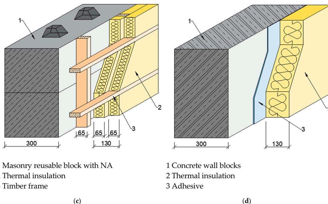
**Figure 1.** Description of Plans: (a) Plan 1, (b) Plan 2, (c) Plan 3, (d) Plan 4.
