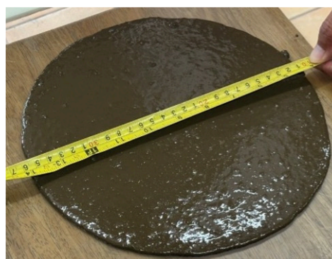
Figure 1. Mini Slump test.
