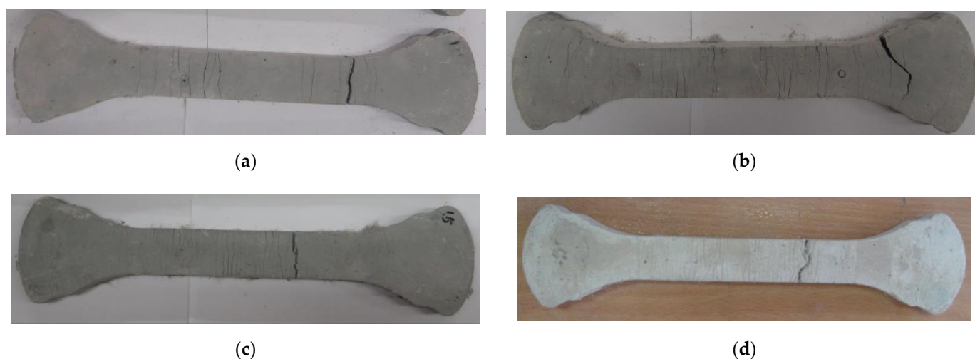
Figure 8. Multiple microcracks of tensile specimens: (a) ASFC100 (PVA 1.00 vol.%); (b) ASFC125 (PVA 1.25 vol.%); (c) ASFC150 (PVA 1.50 vol.%); (d) ASFC200 (PVA 2.00 vol.%).
