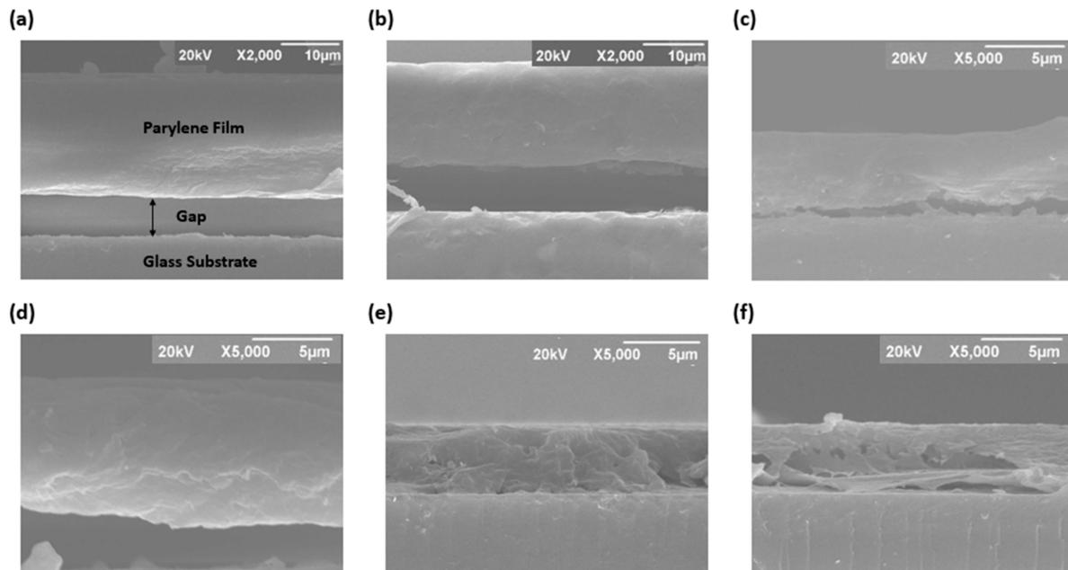
**Figure 4.** Cross-sectional SEM image. (a) Pristine parylene-C. (b) 90 °C annealed parylene-C for 120 min. (c) Parylene-C/AlN 30 min. (d) Parylene-C/AlN 45 min. (e) Parylene-C/AlN 90 min. (f) Parylene-C/AlN 120 min.
