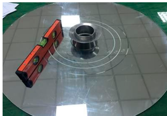
Figure 5. Hagerman mini slump cone apparatus.
