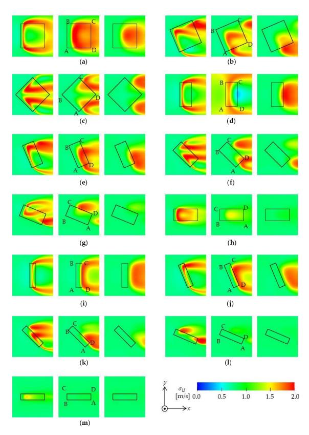
**Figure 8.** Horizontal distributions of the standard deviation of horizontal wind velocity at *z*/*H* = 1.05 (**left**), 1.1 (**middle**) and 1.15 (**right**). (**a**) Case 100\_000; (**b**) Case 100\_225; (**c**) Case 100\_450; (**d**) Case 050\_000; (**e**) Case 050\_225; (**f**) Case 050\_450; (**g**) Case 050\_675; (**h**) Case 050\_900; (**i**) Case 025\_000; (**j**) Case 025\_225; (**k**) Case 025\_450; (**l**) Case 025\_675; (**m**) Case 025\_900.
