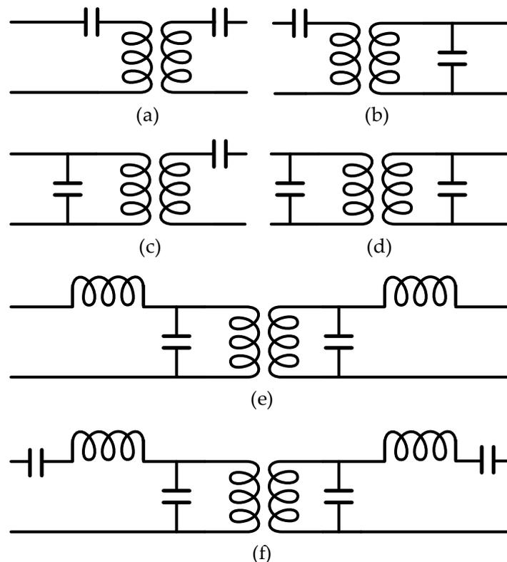
**Figure 5.** Compensation network topologies: (a) SS; (b) SP; (c) PS; (d) PP; (e) LCL; (f) CLCL [24].
