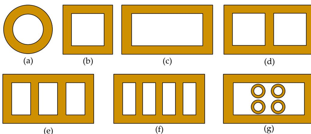
**Figure 6.** Magnetic coupler configurations: (a) circular; (b) square; (c) rectangular; (d) DD; (e) bipolar; (f) DDQ; (g) QDQ [24].
