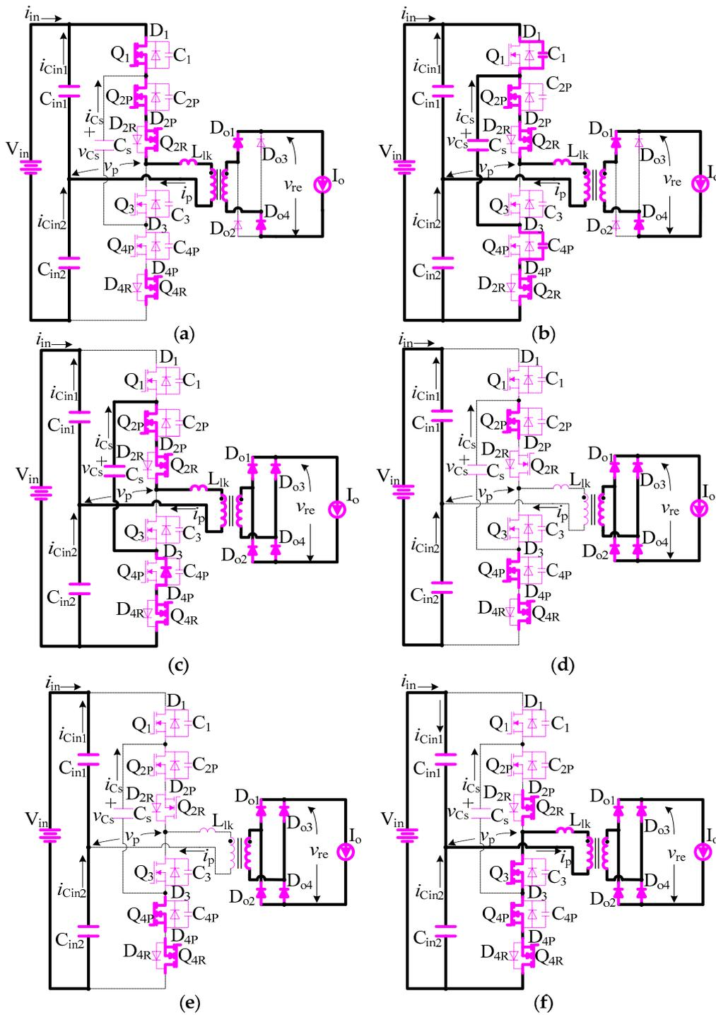
Figure 4. Identical circuits: (a) Mode 1; (b) Mode 2; (c) Mode 3; (d) Mode 4; (e) Mode 5; (f) Mode 6.
