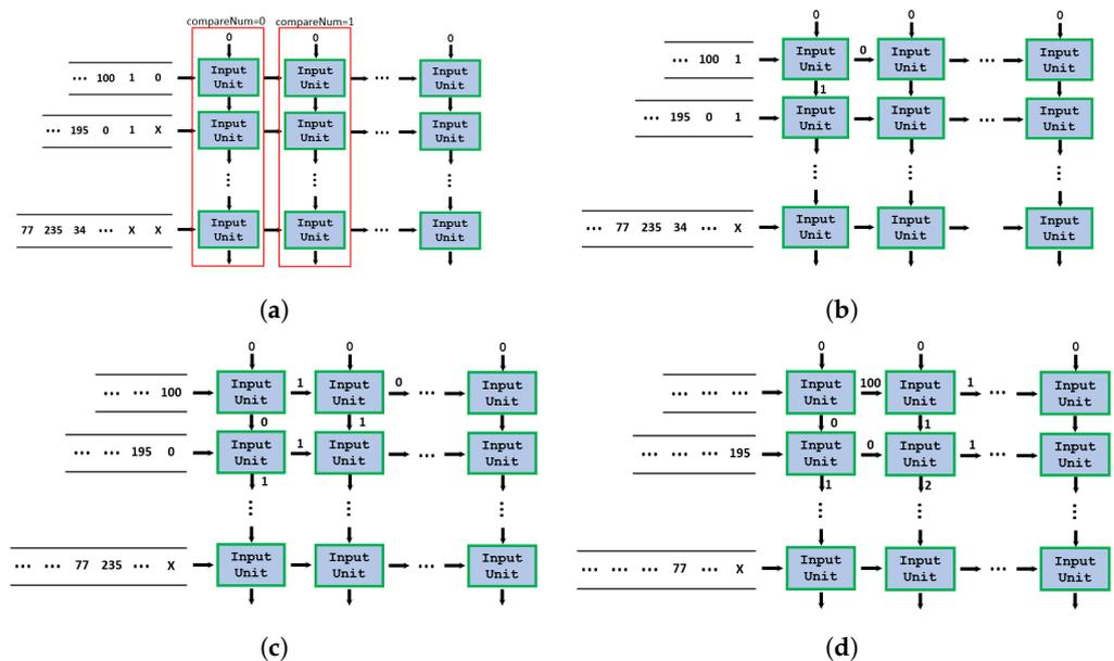
**Figure 2.** The data flow of input units. (a)  $t=0$ . (b)  $t=1$ . (c)  $t=2$ . (d)  $t=3$ .
