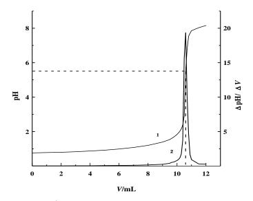
**Figure 2.** 0.10 mol·L<sup>-1</sup> HF potentiometric titration curve. (1. pH-*V*; 2.  $\Delta$ pH/ $\Delta$ V-*V*).
