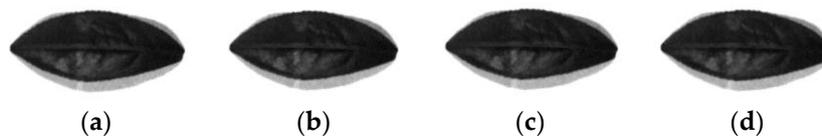
**Figure 12.** Reconstructed images of the 440 nm band of PSSAHCS. (a) 0.10 bpp; (b) 0.15 bpp; (c) 0.20 bpp; (d) 0.25 bpp.
