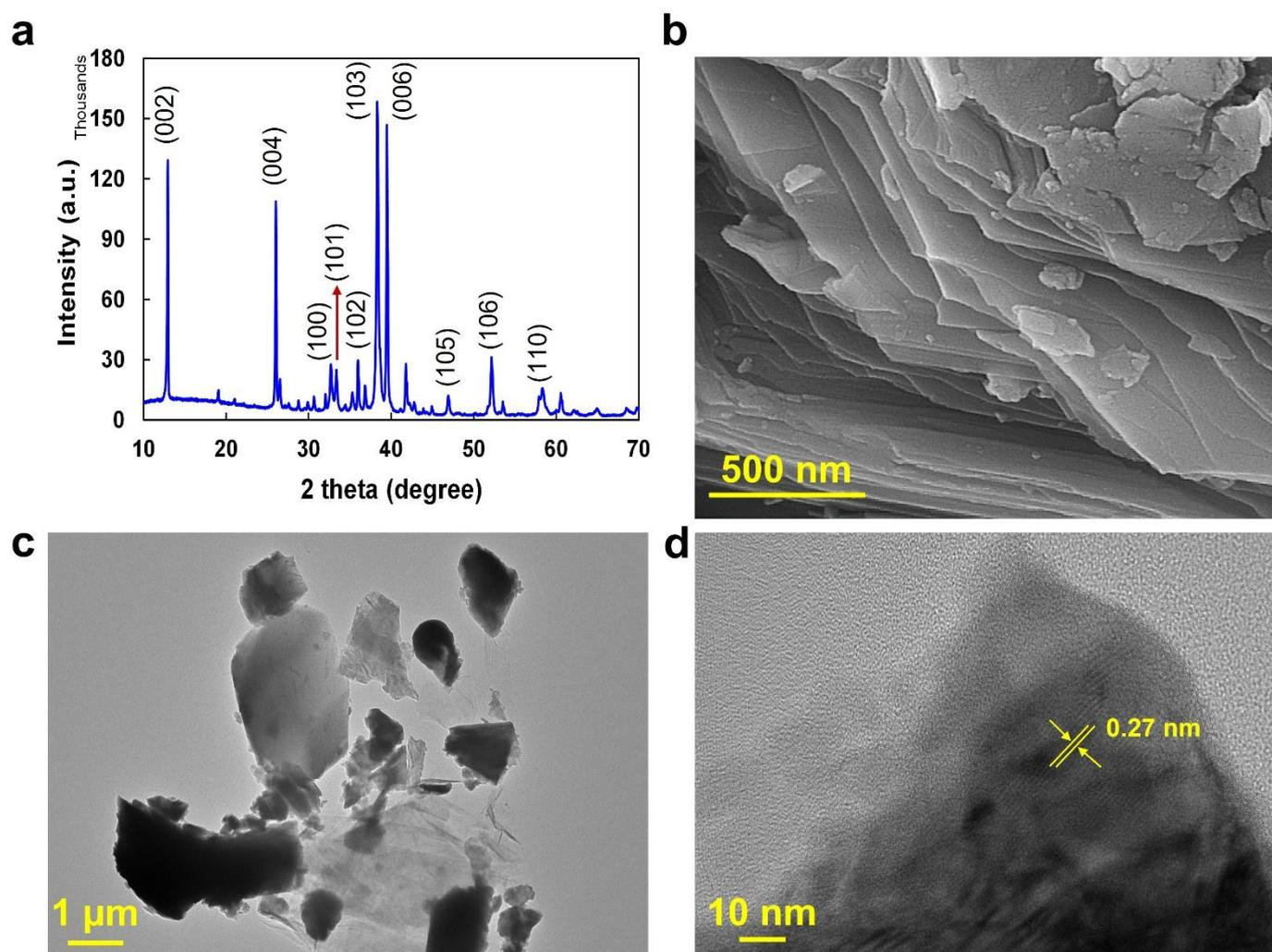
**Figure 1.** (a) XRD pattern, (b) SEM, (c) TEM, and (d) HRTEM micrographs of the  $\text{Ti}_2\text{SnC}$  MP.
