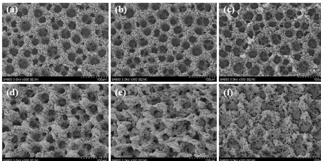
**Figure S10.** The SEM images of Cu/SnO<sub>2</sub> with different SnO<sub>2</sub> deposition time, (a) 0 min, (b) 5 min, (c) 15 min, (d) 30 min, (e) 45 min, (f) 60 min.
