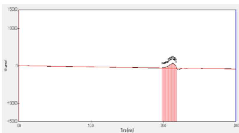
**Figure S2:** SEC trace of P1  $M_n$ : 47000,  $M_w$ : 49000,  $M_w/M_n$ : 1.04
