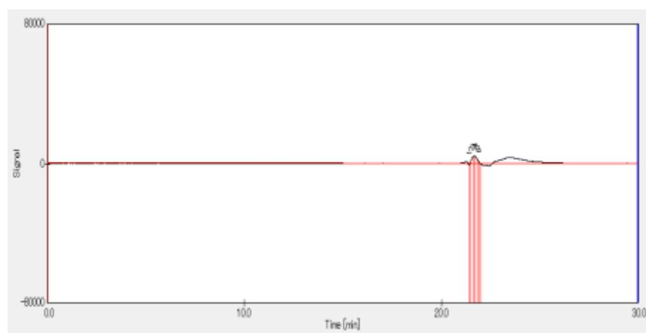
**Figure S5:** SEC trace of P2C  $M_n$ : 54000,  $M_w$ : 55000,  $M_w/M_n$ : 1.02
