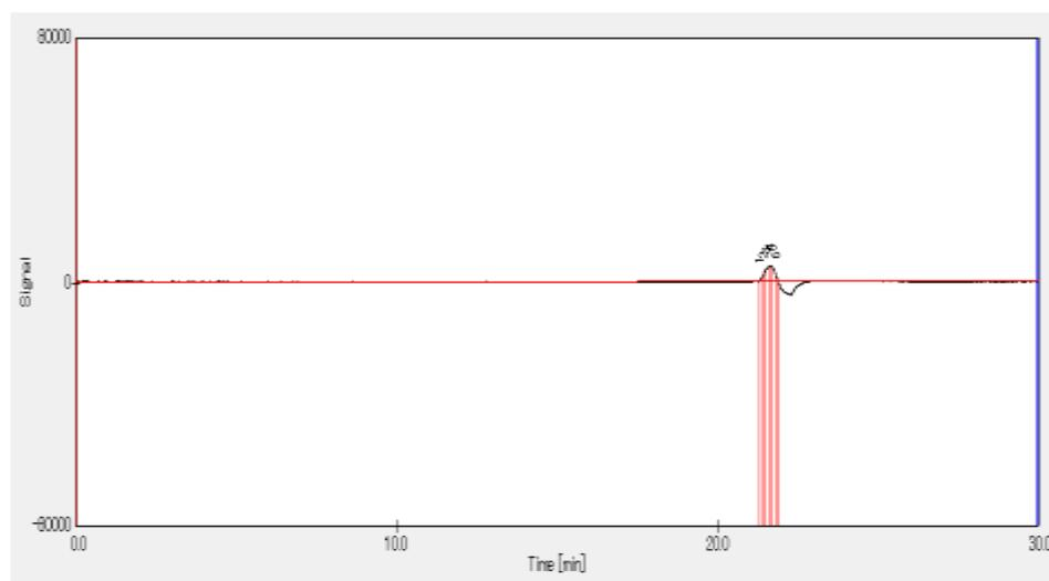
**Figure S8: SEC trace of P3  $M_n$ : 74000,  $M_w$ : 75000,  $M_w/M_n$ : 1.01**
