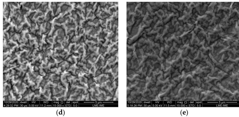
**Figure 6.** SEM micrographs for: (a) CA substrate; (b) 40-ly rGO FM; (c) 60-ly rGO FM; (d) 80-ly rGO FM; (e) 100-ly rGO FM.
