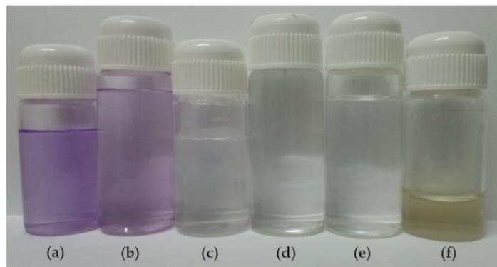
**Figure 9.** (a) Feed solution; permeation solutions: (b) CA substrate; (c) 40-ly rGO FM; (d) 60-ly rGO FM; (e) 80-ly rGO FM; (f) 100-ly rGO FM.
