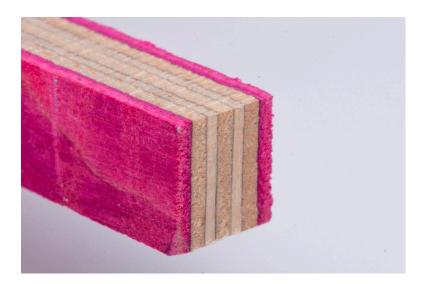
Figure 8. Edge Wise Strip Orientation.
