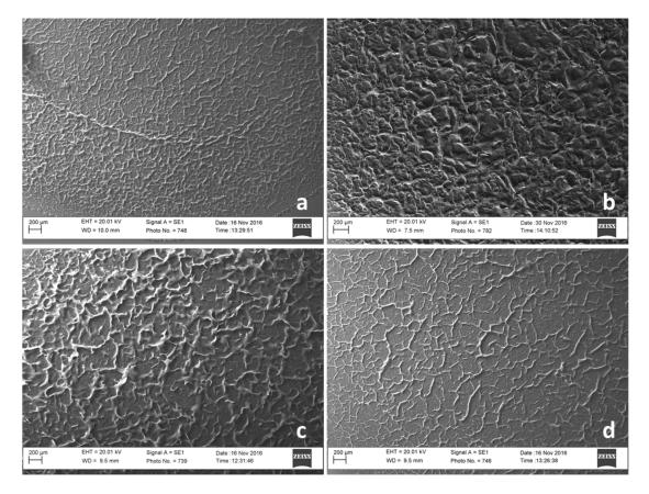
**Figure 4.** SEM images of 1.5% (w/w) xerogels. (**a**) BBO6-Me (n-octanol), (**b**) BBO8-Me (n-octanol), (**c**) BBO8-Et (ethanol), (**d**) BBO10-Et (n-octanol).
