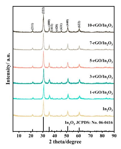
Figure 2. XRD patterns of the pure  $In_2O_3$ , 1-rGO/ $In_2O_3$ , 3-rGO/ $In_2O_3$ , 5-rGO/ $In_2O_3$ , 7-rGO/ $In_2O_3$ , and 10-rGO/ $In_2O_3$ .
