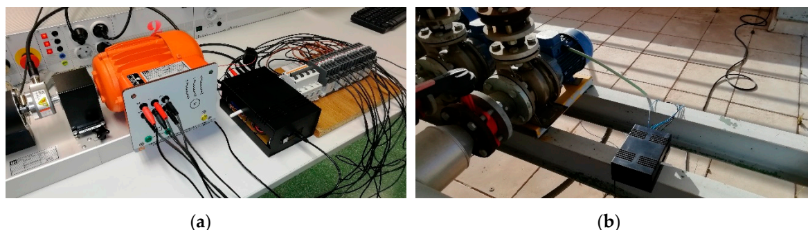
Figure 9. Final assemblies for motor test: (a) IM 0.37 kW (IMEMSL #1); (b) IM 3.0 kW (IMEMSL #4).
